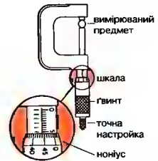
Мікрометр Промисловий мікрометр з ноніусом
